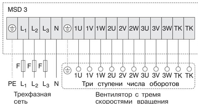
**Электронные приборы фазового управления и регулирования. Предназначены для установки в шкаф комплектного распределительного устройства для трехфазной сети 400 В, 50/60 Гц.**
