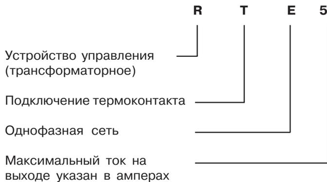
**RTE 12** – корпус из стального листа, имеющего покрытие из синтетического материала. Степень защиты IP 54.
