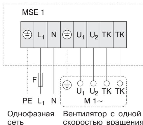
Коммутационный аппарат односкоростной для электродвигателей трехфазного тока с одной скоростью вращения.
