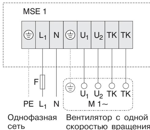
Коммутационный аппарат односкоростной для электродвигателей переменного тока с одной скоростью вращения.
