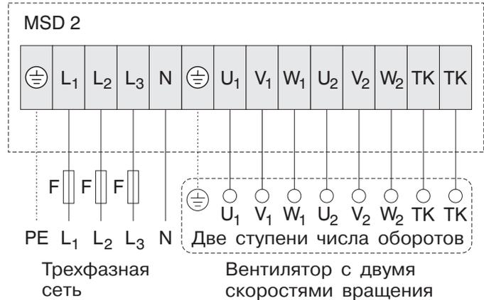
Коммутационный аппарат двухскоростной для электродвигателей трехфазного тока с двумя скоростями вращения (переключение Y / Δ).
