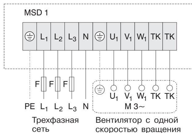
Коммутационный аппарат односкоростной для электродвигателей трехфазного тока с одной скоростью вращения (автоматический разгон Y/Δ).
