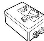
**Электронные приборы фазового управления и регулирования давлением предназначены для монтажа на стене и рассчитаны на однофазную сеть 230 В, 50 Гц.**
