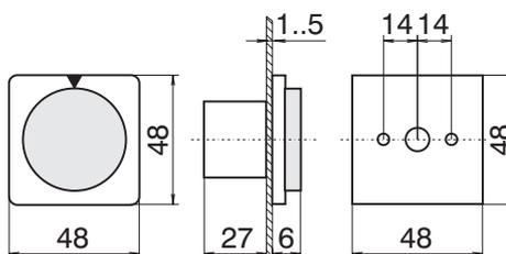
**Датчики давления PU 2, PU 5, PU 10**
